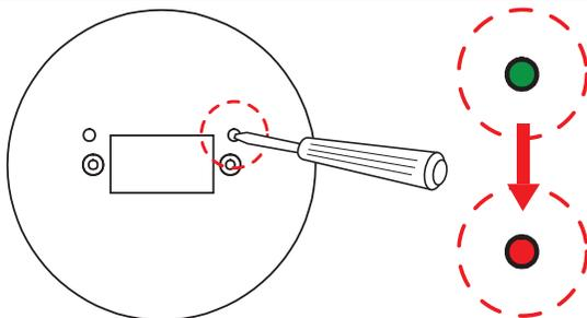
Den Hauscodierungstaster bei anliegender Versorgungsspannung durch das kleine Loch im Gehäuse drücken, bis die LED-Farbe von GRÜN zu ROT wechselt. Anschließend loslassen.
