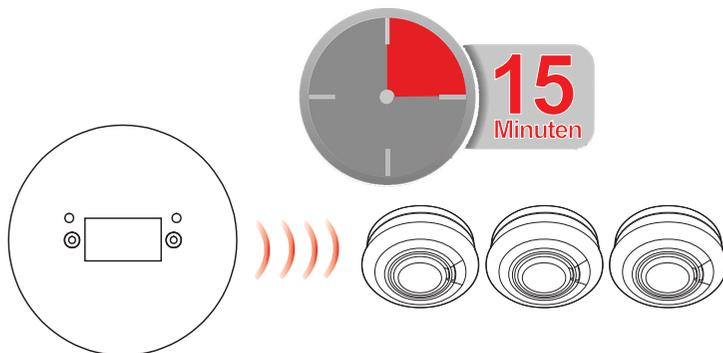
Ab jetzt steht ein Zeitfenster von 15 Minuten für die Vernetzung des Relaismoduls mit den anderen Komponenten des Funksystems zur Verfügung.
